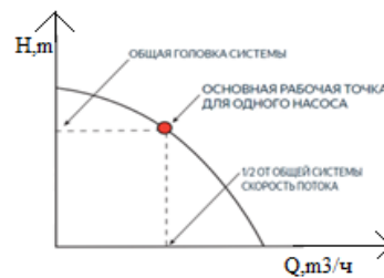
Рисунок 1.5 – Базовая рабочая точка параллельного насоса.
