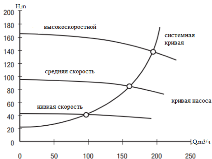
Рисунок 1.3 – Кривые производительности многоскоростного насоса.
