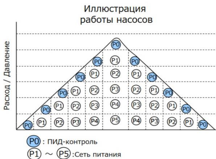
Рисунок 1.19 – Иллюстрация каскадного подключения и отключения насосов
